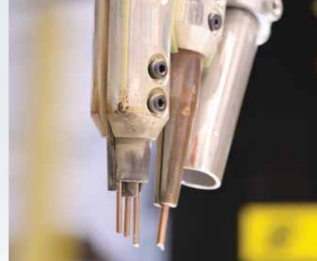
Технология ICE™ - Дополнительный "холодный" электрод
